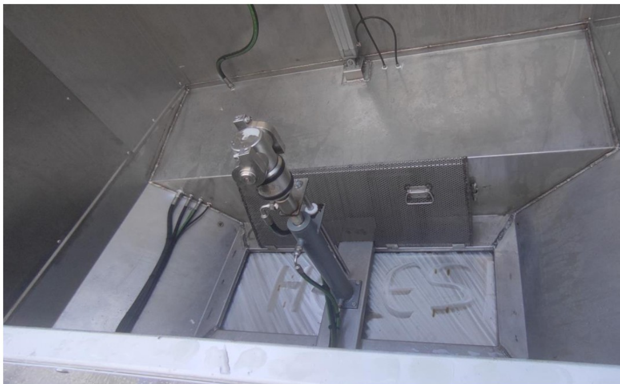
ΛΕΚΑΝΗ ΑΠΟΣΤΡΑΓΓΙΣΗΣ ΚΑΙ ΜΗΧΑΝΙΣΜΟΣ ΦΙΛΤΡΑΡΙΣΜΑΤΟΣ
