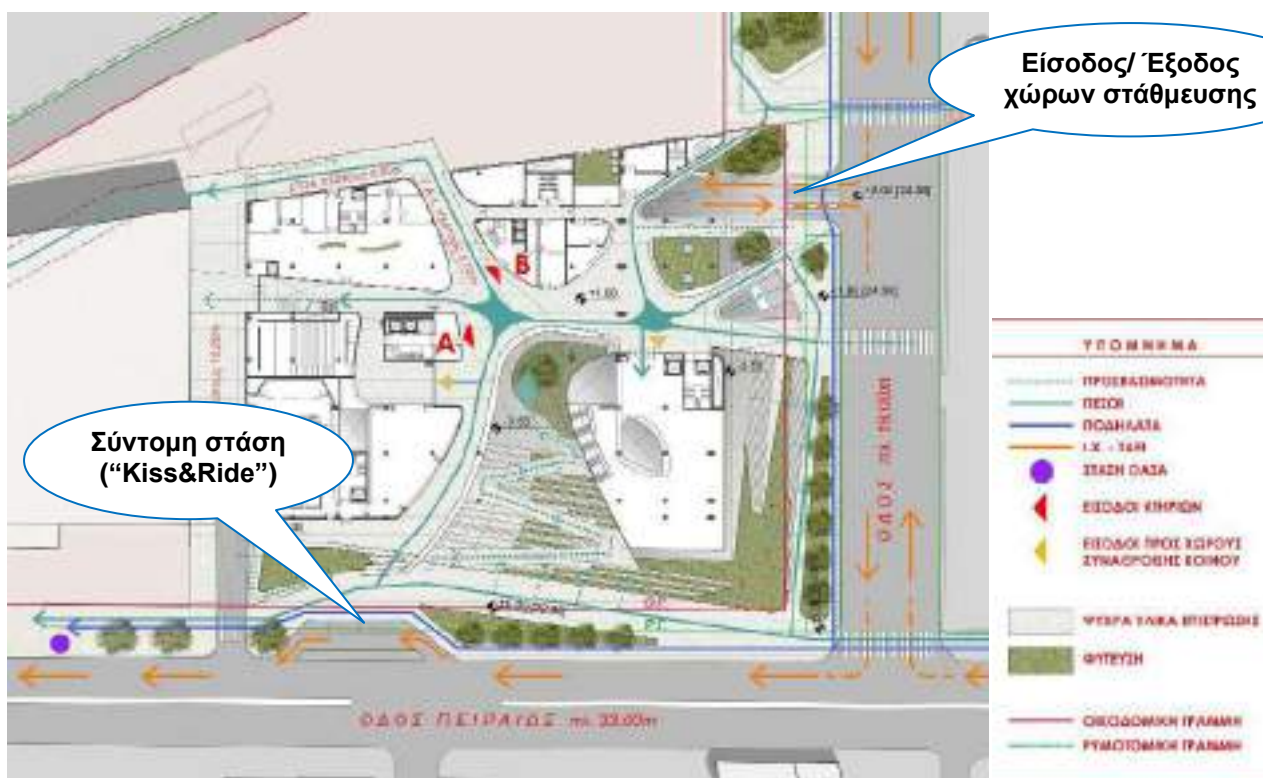
Εικόνα 4-1: Κάτοψη νέου Κτηρίου της Γ.Γ.Υ. του Υπουργείου Υποδομών & Μεταφορών: "Κάτω πλατεία" – κύρια είσοδος – σύνθεση αναβαθμών & ράμπας
