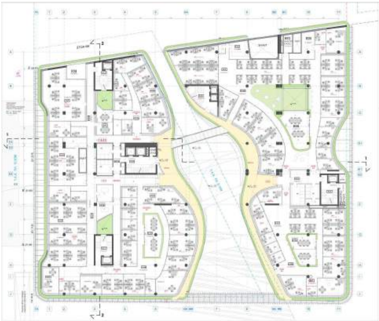
Εικόνα 6-9: Διερεύνηση διάταξης γραφειακών χώρων σε ενότητες διαχωρισμάτων +13.30
