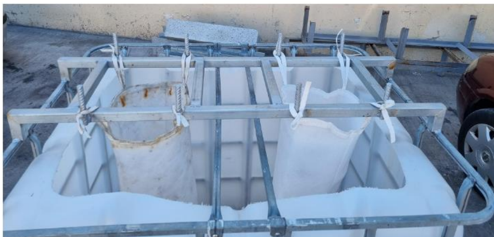
Εικόνα 6.2: Σύστημα φιλτρώσακκων εγκατάστασης.
